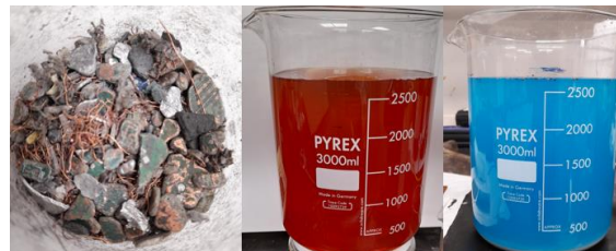
Ilustración 3. Circuitos antes y después del bio-leaching
